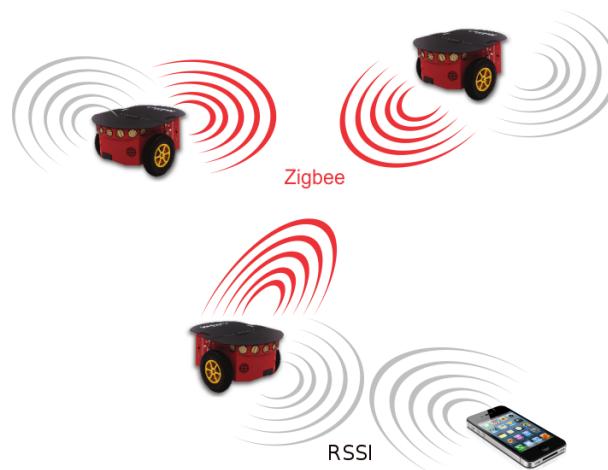
Figura 4.1: Tecnologias de redes sem fio para a comunicação entre os robôs do enxame.
