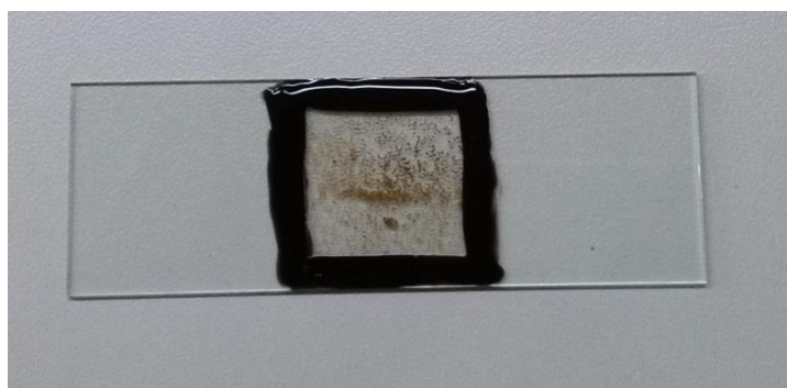
FIGURA 1 – LÂMINAS SEMI-PERMANENTES VEDADAS COM ESMALTE COMERCIAL DE UNHA FONTE: O autor (2014)
