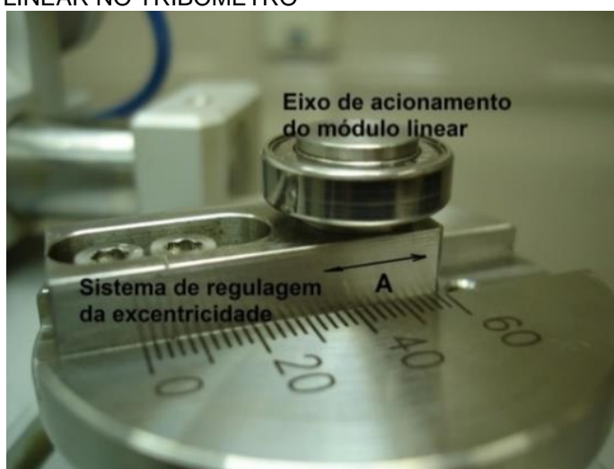
FIGURA 43 – AJUSTE DA AMPLITUDE DE DESLOCAMENTO DO MÓDULO LINEAR NO TRIBÔMETRO
