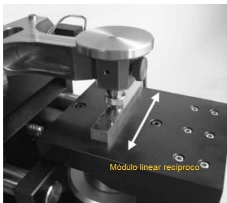
FIGURA 22 – TRIBÔMETRO COM MÓDULO LINEAR RECÍPROCO ACOPLADO
