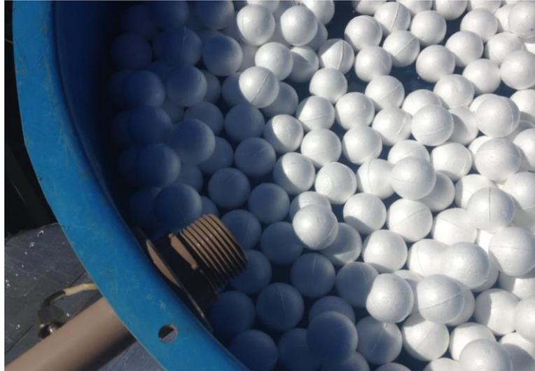
FIGURA 3.5: ESFERAS DE POLIESTIRENO EXPANDIDO DE 3 CM DE DIÂMETRO.
