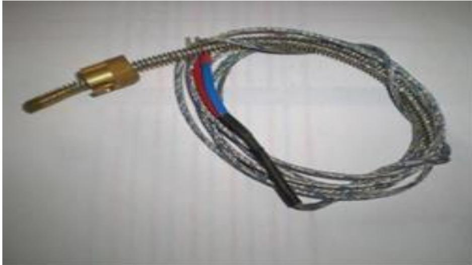
FIGURA 3.6: TERMOPAR TIPO J UTILIZADO PARA AS MEDIÇÕES DE TEMPERATURA.
