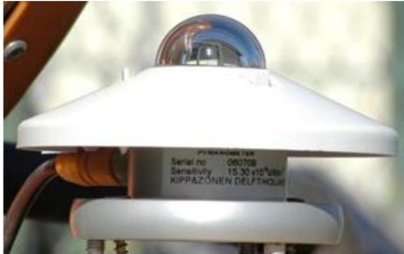
FIGURA 3.10: PIRANÔMETRO USADO PARA MEDIÇÃO DA RADIAÇÃO SOLAR.
