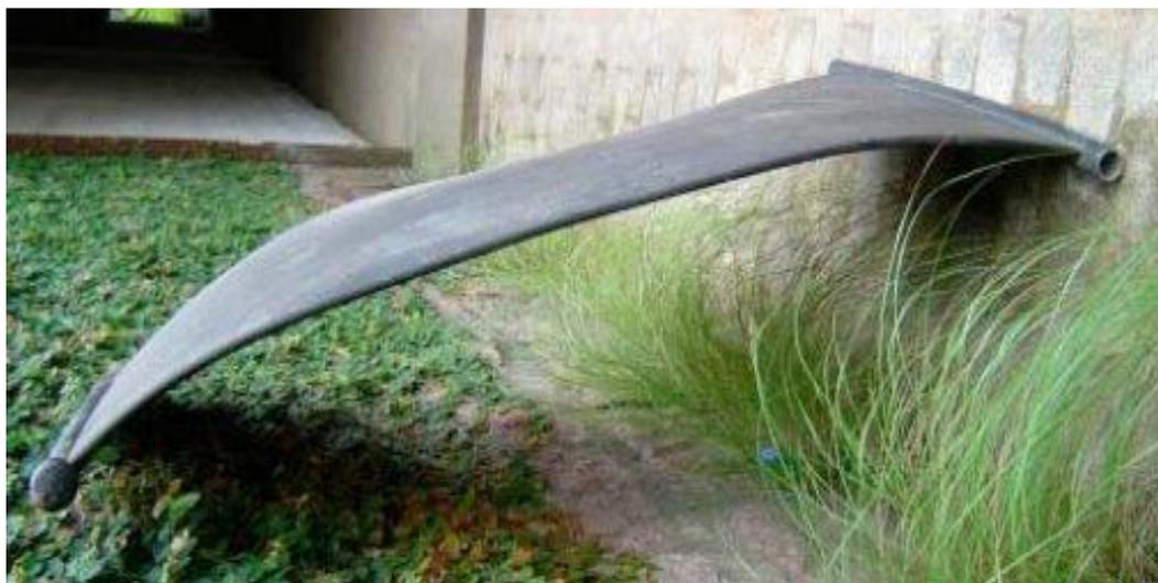
FIGURA 2.4: DEFORMAÇÃO EM PLACA DE PVC ALVEOLAR.
