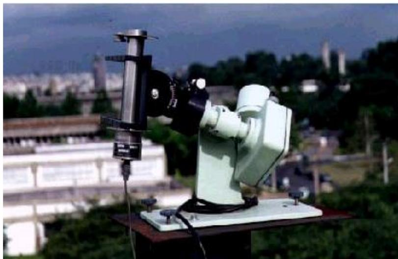
FIGURA 2.20: PIROHELIÔMETRO DE INCIDÊNCIA NORMAL.
