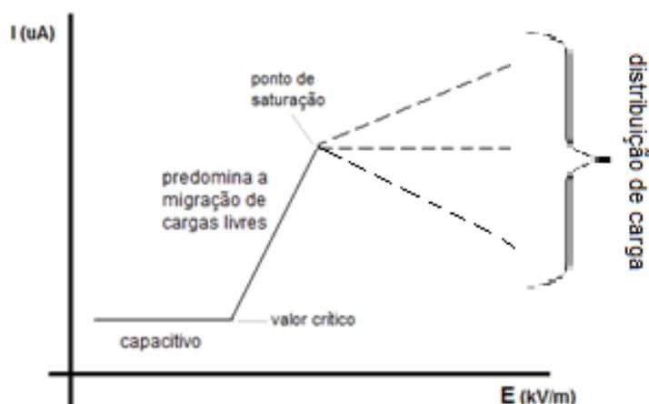
**Figura 8.4:** Gráfico da generalização do comportamento observado para as curvas de corrente em função do campo elétrico aplicado.
