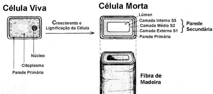
Figura1–Esquema do crescimento celular e da formação da fibra. **Fonte: Teoria do Cozimento, METSO, 2013.**
