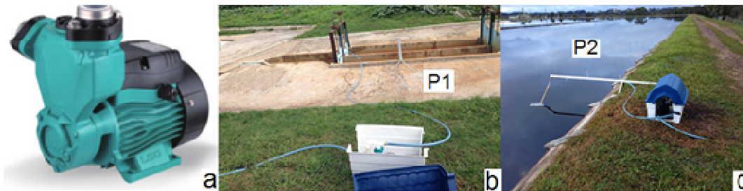
FIGURA 5.8 – BOMBA AUTOASPIRANTE a) ILUSTRAÇÃO DA BOMBA; b) BOMBA PRÓXIMA AO P1 E c) BOMBA PRÓXIMA AO P2
