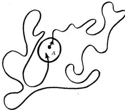
Figura 2.3: Trajetória em uma região limitada do espaço de fase cruzando a área A de volume \Gamma_A . Figura retirada da Ref. [40].
