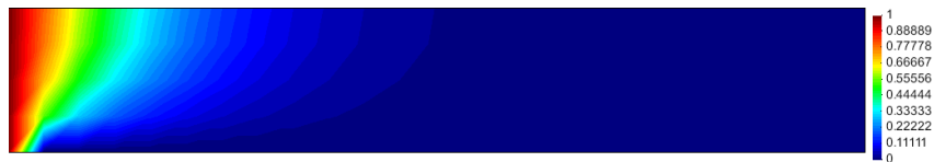
Figura 27: Concentração do contaminante, em mg/L, no instante de tempo t=80 \text{ s} , utilizando D=2 \text{ m}^2/s
