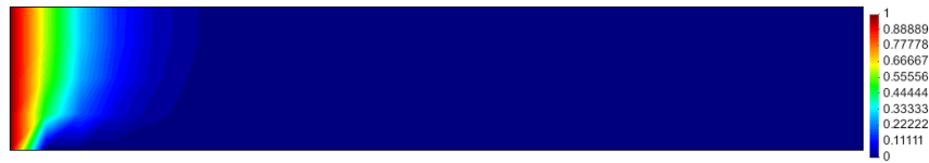
Figura 24: Concentração do contaminante, em mg/L, no instante de tempo t=2 \text{ s} , utilizando D=2 \text{ m}^2/s
