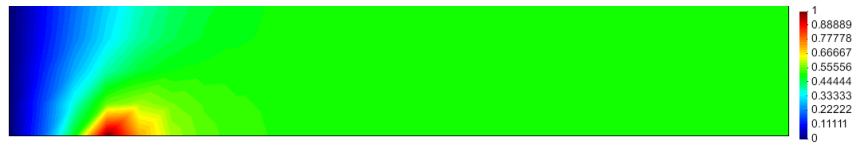
Figura 33: Concentração do contaminante, em mg/L, no instante de tempo t=112s
