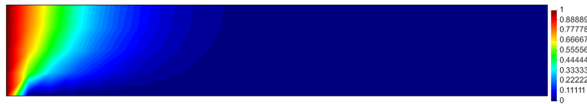
Figura 25: Concentração do contaminante, em mg/L, no instante de tempo t=10 \text{ s} , utilizando D=2 \text{ m}^2/s
