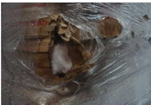
Figura 10 Carga em carreta mal acondicionada e caixa avariada.
