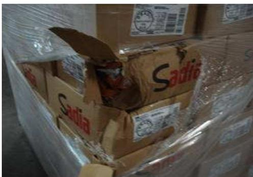
Figura 9 Carga em carreta mal acondicionada e caixa avariada.
