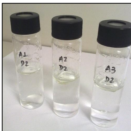
FIGURA 50 – Aspecto visual observado para os sistemas de equilíbrio de fases diesel D2:água após t_{eq} 7 dias, T 20\pm 2 °C, 200 rpm, para uma proporção diesel:água 1:20 ( v v^{-1} ).
