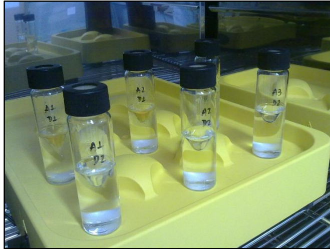
FIGURA 21 – Sistema empregado para os experimentos envolvendo sistemas de equilíbrio de fases (método de agitação lenta).
