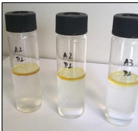
FIGURA 49 – Aspecto visual observado para os sistemas de equilíbrio de fases diesel D1:água após t_{eq} 7 dias, T 20\pm 2 °C, 200 rpm, para uma proporção diesel:água 1:20 ( v v^{-1} ).
