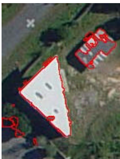
FIGURA 59 - RECORTE 03 - FAIXA 5 - FILTRO ALTIMÉTRICO
