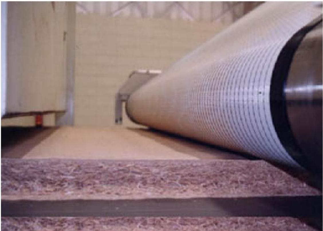
**Figura 4. Detalhe da prensagem do colchão de MDP.**
