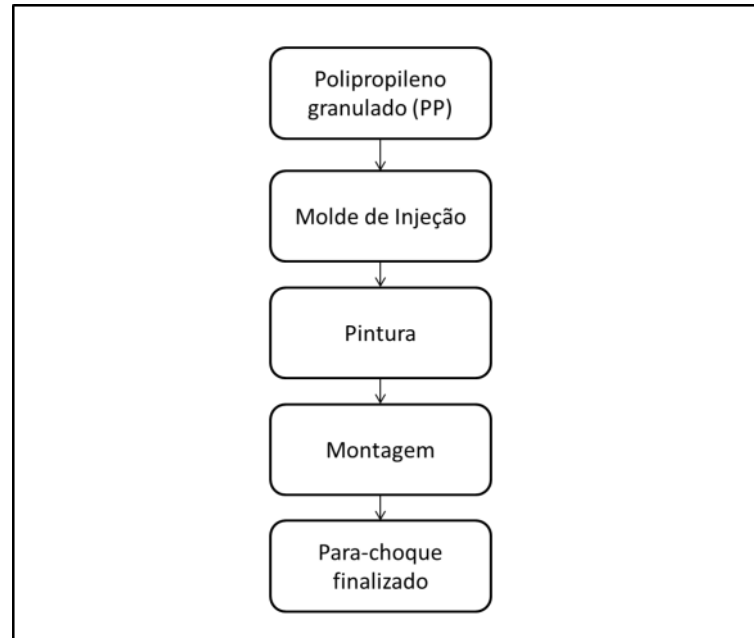
FIGURA 3 – ANÁLISE DE INVENTÁRIO DE UMA UNIDADE DE PRODUÇÃO FONTE: Adaptado de HONGSHEN e MING (2013, p. 29)
