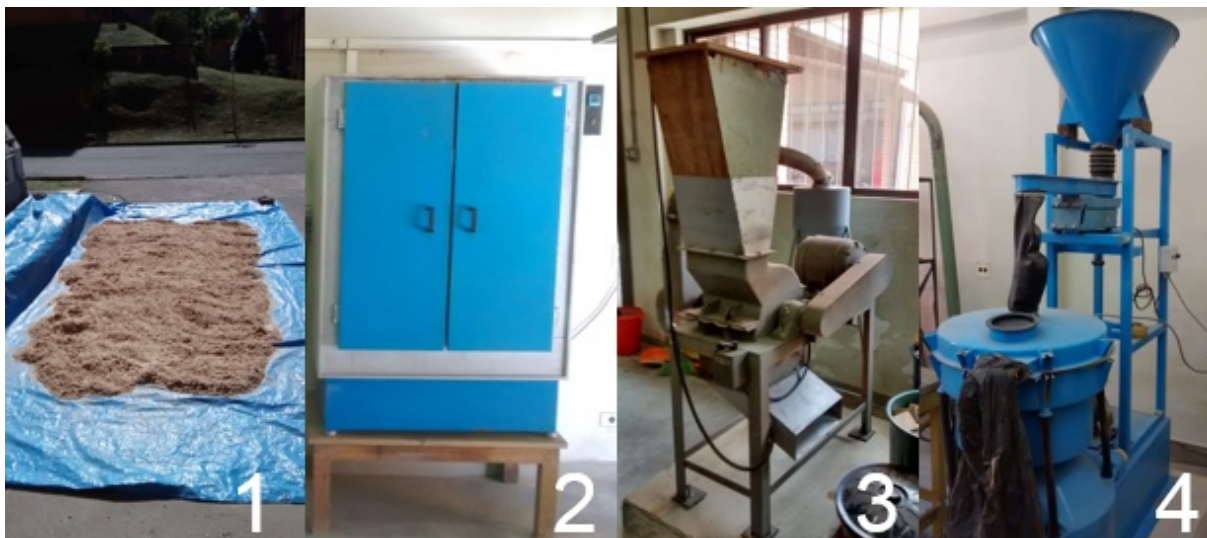
FIGURA 11 - PROCESSOS DE PREPARO DAS PARTÍCULAS EM ESCALA LABORATORIAL 1) SECAGEM AO AR LIVRE; 2) SECAGEM FORÇADA EM ESTUFA CONVENCIONAL; 3) MOINHO DE MARTELO; 4) PENEIRA FONTE: O autor (2015)
