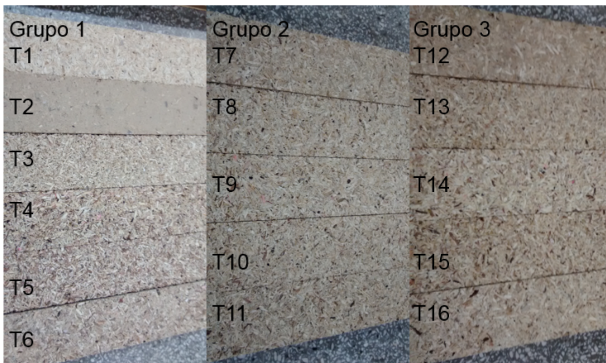
FIGURA 16 – ASPECTOS VISUAIS DOS PAINÉIS PRODUZIDOS E SEUS RESPECTIVOS GRUPOS
