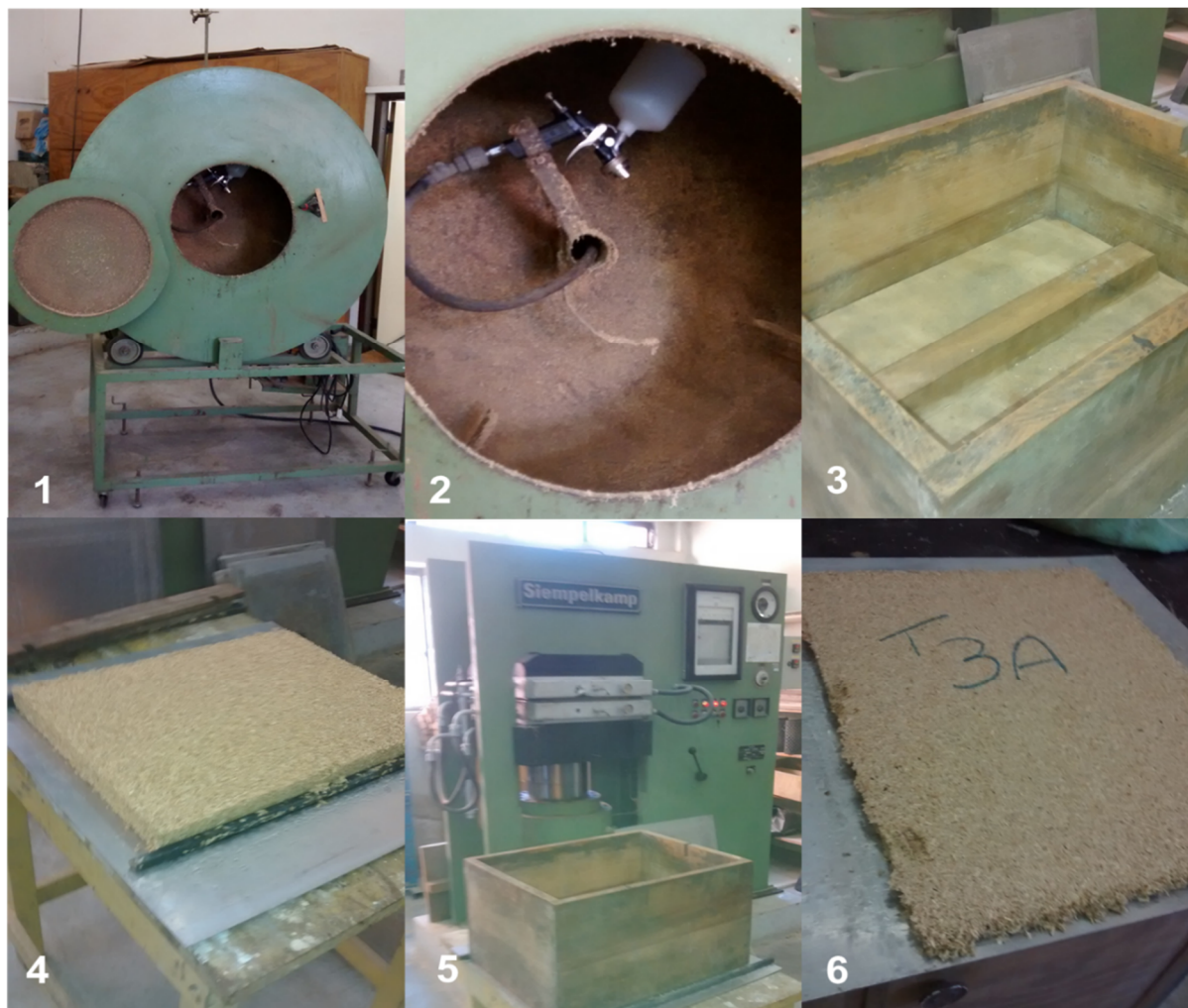
FIGURA 14 - ETAPAS DO PROCESSO DE PRODUÇÃO DOS PAINÉIS 1) ENCOLADEIRA; 2) SISTEMA DE ASPERSÃO DA ENCOLADEIRA; 3) CAIXA FORMADORA; 4) COLCHÃO FORMADO; 5) Prensagem dos painéis; 6) Painel após prensagem FONTE: O autor (2015)
