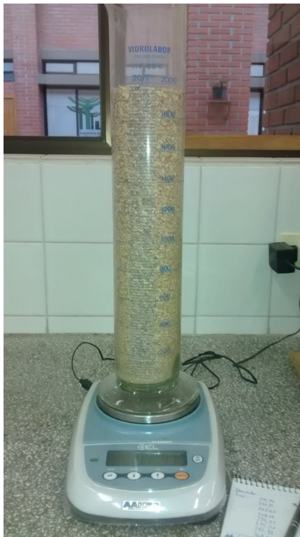
FIGURA 13 - MÉTODO DE OBTENÇÃO DA MASSA ESPECÍFICA A GRANEL DAS PARTÍCULAS FONTE: O autor (2015)
