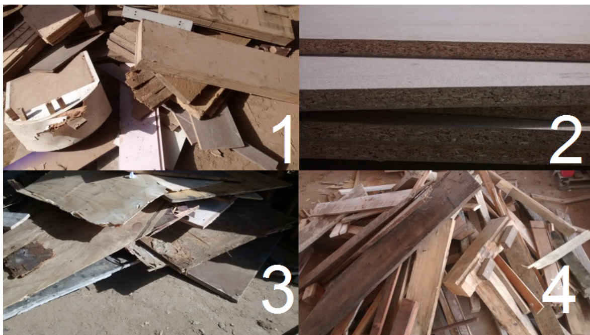
FIGURA 8 - RESÍDUOS SÓLIDOS CLASSIFICADOS 1) MDF; 2) AGLOMERADO; 3) COMPENSADO; 4) MADEIRA MACIÇA FONTE: O autor (2015)
