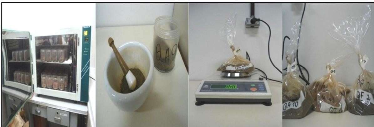
FIGURA 4 - SECAGEM, MOAGEM, PESAGEM E ACONDICIONAMENTO DAS AMOSTRAS DE SOLO COLETADAS NAS PARCELAS DE ESTUDO, LOCALIZADAS EM SÃO JOÃO DO TRIUNFO/PR.
