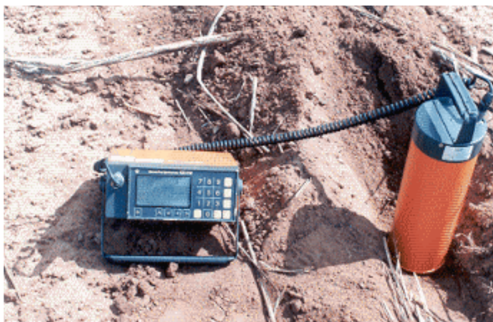
Figura 10. Aquisição de dados gamaespectrométrico dos solos - Área 2
