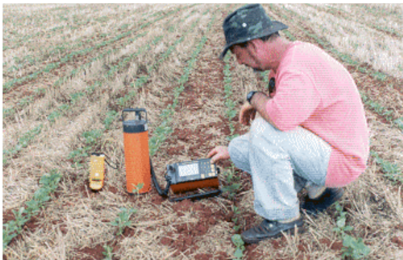
Figura 7 Aquisição de dados gamaespectrométricos dos solos - Área 1
