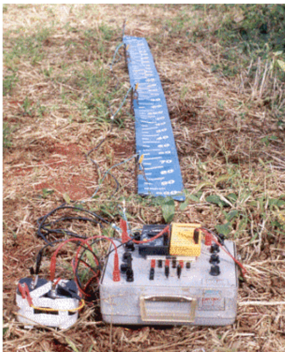
Figura 13. Aquisição de dados da resistividade elétrica – Área 1
