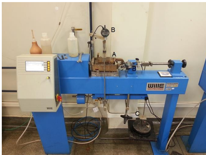
Figura 5-5 - Equipamento utilizado para ensaio de cisalhamento direto: a - célula de cisalhamento, b - Marcadores de tensão cisalhante e deformação vertical, c - sistema de transmissão de carga.
