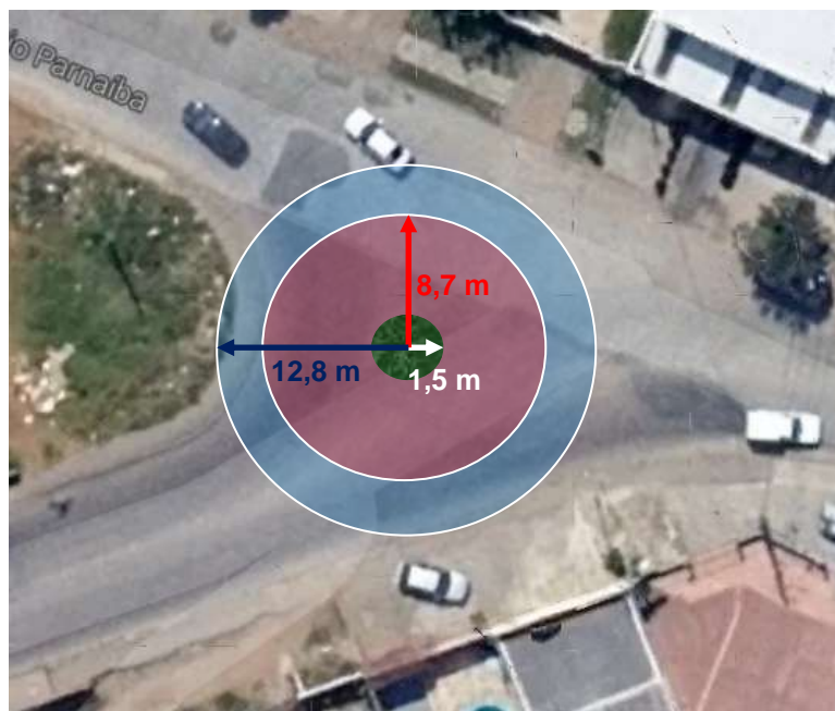
Figura 4.35 – Município de Pinhais, traçado do raio de giro na rótula das ruas Rio Paranaíba e Rutildo Pulido
