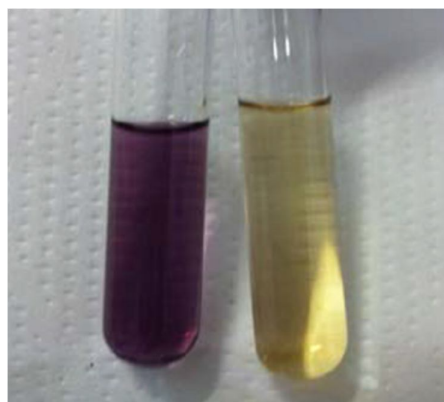
FIGURA 09 – SOLUÇÃO DE DPPH A 40 µg/mL, ANTES E DEPOIS DE RECEBER UM ELÉTRON DE UMA SUBSTÂNCIA ANTIOXIDANTE
