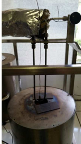
FIGURA 9- - FOTO DO REATOR EM FORMATO DE “U” ACOPLADO AO REFORMADOR.
