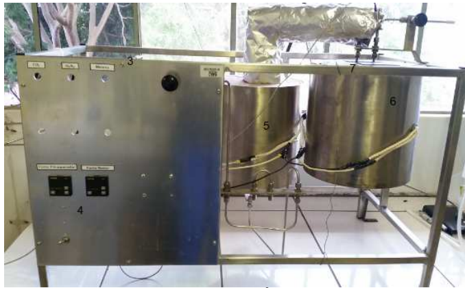
FIGURA 8- REATOR CONSTRUÍDO PARA A REFORMA A SECO.
