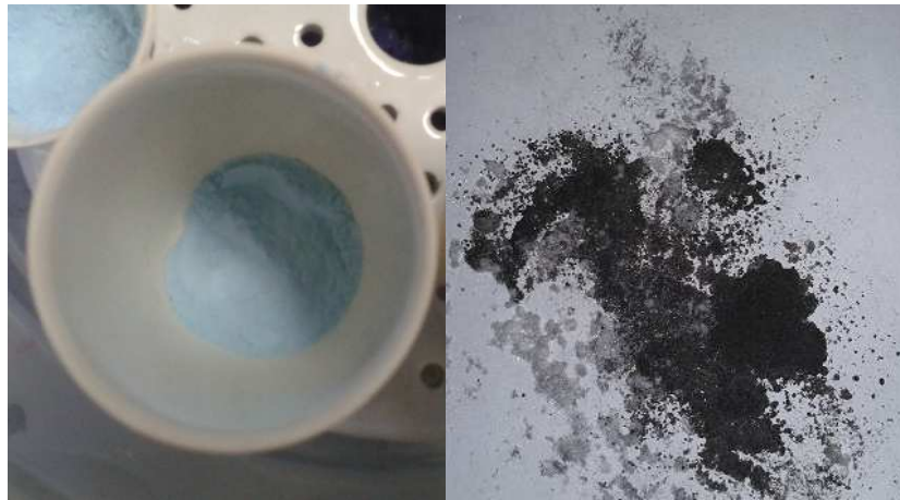
FIGURA 25- CATALISADOR 15% Ni/Al 2 O 3 ANTES E APÓS A REAÇÃO.
