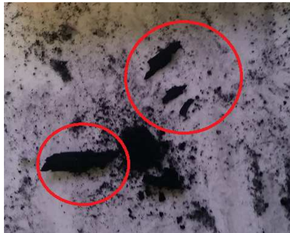
FIGURA 20- FORMAÇÃO DE COQUE NO CATALISADOR 15% Ni/Al 2 O 3 APÓS 4 h DE REAÇÃO À 700 °C COM VHSV= 30 L.h -1 .g cat -1 .
