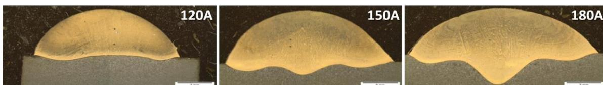
Figura 19 - Geometria dos cordões soldados sobre aço API 5L X70: 120A, 150A e 180A
