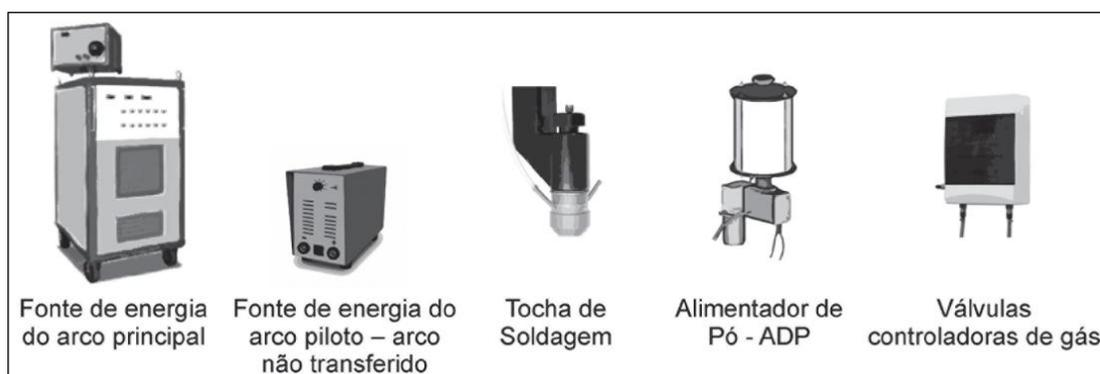
Figura 4 - Componentes do equipamento de PTA
