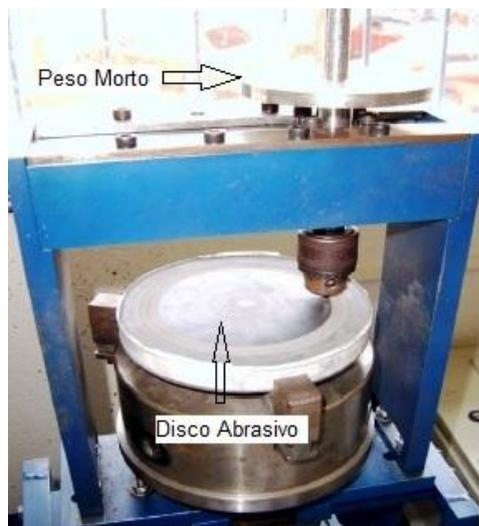
Figura 16 - Fotografia mostrando o equipamento utilizado nos ensaios de desgaste tipo pino sobre disco.
