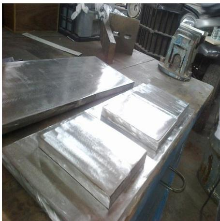
Figura 12 - Substratos com superfície preparada por lixamento para a deposição.
