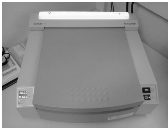
Figura 18: Espectrômetro de fluorescência de raios X ED-XRF MiniPal 4
