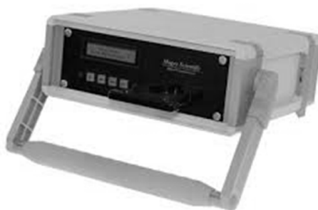
Figura 19: Transmissômetro ótico OT 21
