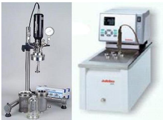
FIGURA 10 – REATOR MODELO *MINICLAVE-DRIVE* BUCHIGLASSUSTER E CIRCULADOR MODELO JULABO<sup>®</sup>-HE4 COM CONTROLE DE AQUECIMENTO UTILIZADOS DURANTE AS REAÇÕES. FONTE: MANUAL TÉCNICO DOS APARELHOS.
