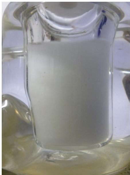
FIGURA 9. CÉLULA DE EQUILÍBRIO COM TRÊS COMPONENTES SOB AGITAÇÃO. A TURVAÇÃO DO MEIO DENOTA A HETEROGENEIDADE DO SISTEMA.
