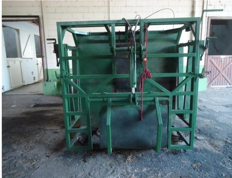
Figura 4 – Vista frontal do tronco tombador hidráulico da CBPR - USP.
