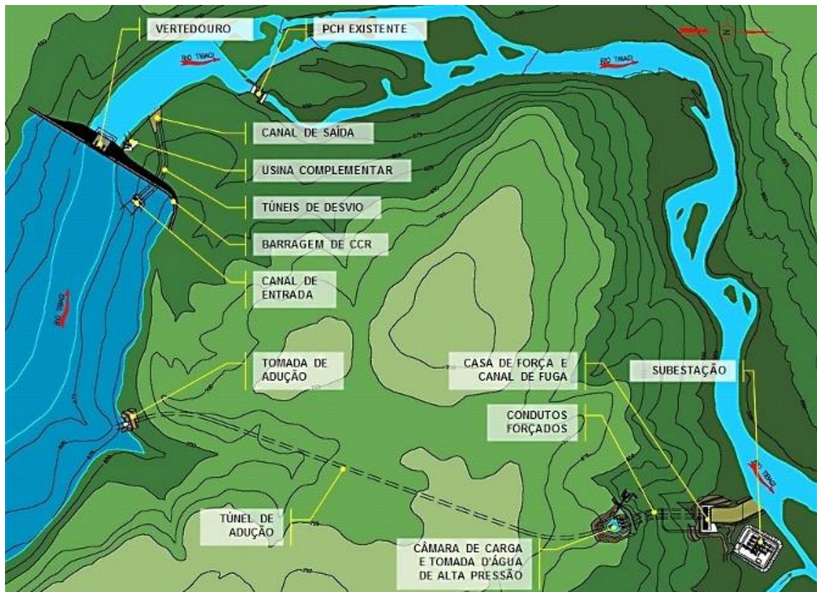
ILUSTRAÇÃO 2 – PARTES DA USINA DE MAUÁ - 2013 FONTE: Consórcio Cruzeiro do Sul
