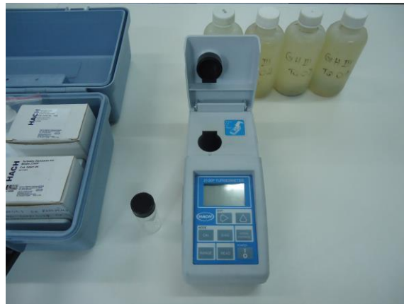
Figura 7: Turbidímetro: HACH 2100P
