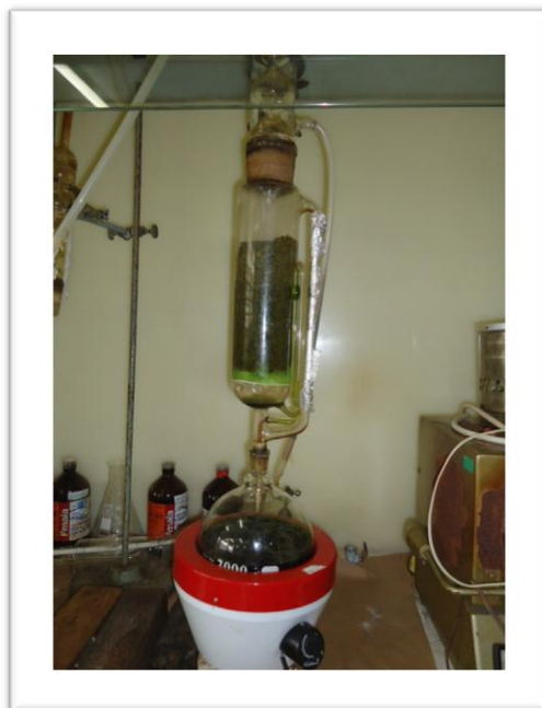
FIGURA 8 – APARELHO DE SOXHLET UTILIZADO PARA OBTENÇÃO DO EXTRATO E FRACIONAMENTO. FONTE: ACERVO PESSOAL DE CRISTIANE DA SILVA PAULA, 2012.
