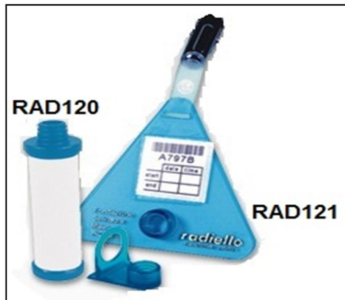
**FIGURA 9** - CONJUNTO PARA AMOSTRAGEM DE  $H_2S$
