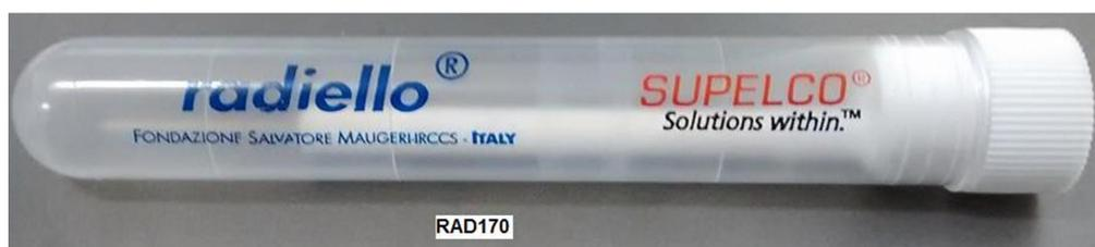
**FIGURA 10** - CARTUCHO ADSORVENTE PARA  $H_2S$
