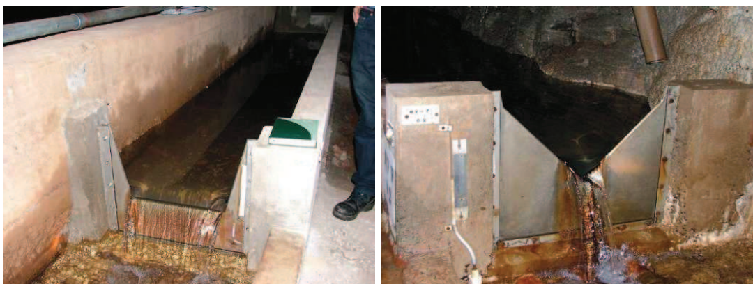
Figura 6 – Medidores de vazão, sendo trapezoidal a esquerda e triangular ( 90^\circ ) a direita Fonte: Silveira (2012)
