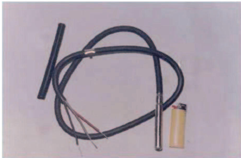
Figura 5 – Termômetro elétrico, conectado ao cabo de leitura Fonte: Silveira (2012)
