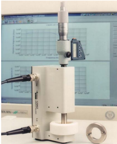
Figura 32 – Célula de medição utilizada nos ensaios de espectroscopia dielétrica em amostras de óleo isolante
