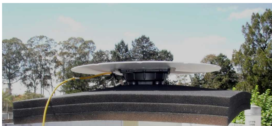
FIGURA 18- ANTENA TRM22020.00+GP ACOPLADA AO AEM-LAGE FONTE: AUTORA (2014)
