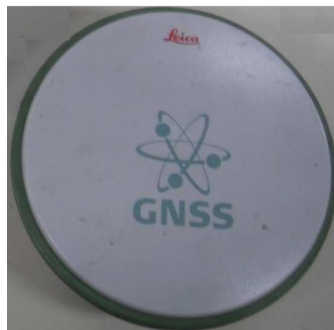
FIGURA 47- ANTENA LEIAX1203 GNSS FONTE: AUTORA (2014)
