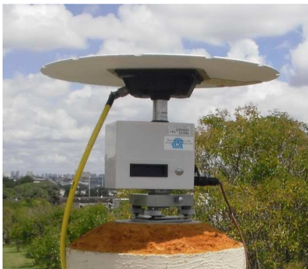
FIGURA 44- ANTENA TRM22020.00+GP FONTE: AUTORA (2014)
