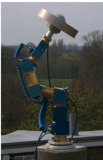
FIGURA 29- ROBÔ UTILIZADO NA CALIBRAÇÃO ABSOLUTA EM CAMPO FONTE: GEOPP (2011)
