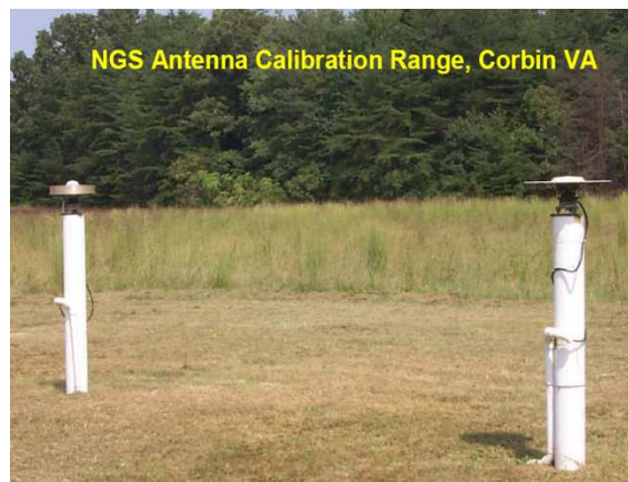
FIGURA 32- CAMPO DE CALIBRAÇÃO RELATIVA DO NGS (CORBIN, VIRGINIA) FONTE: MADER E WESTON (2008)
