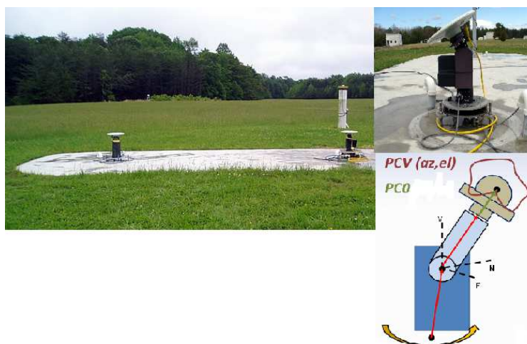
FIGURA 33- CALIBRAÇÃO ABSOLUTA DO NGS (CORBIN, VIRGINIA) FONTE: BILICH ET AL (2010)
