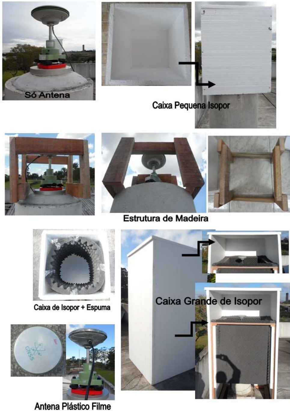
FIGURA 39- EXPERIMENTOS PARA ANÁLISE DO MATERIAL A SER EMPREGADO NAS ESTRUTURAS DOS AMBIENTES CONTROLADOS FONTE: AUTORA (2014)
