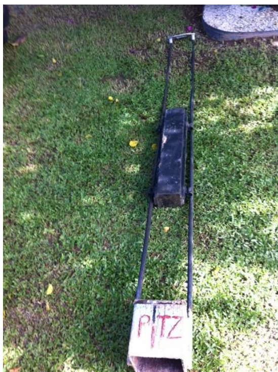
FIGURA 3.28 - ADAPTAÇÃO UTILIZADA EM SONDA SPT FONTE: DO AUTOR
