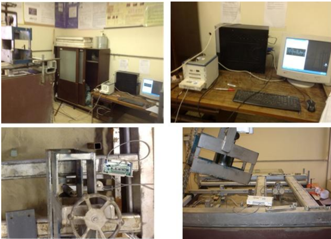
FIGURA 3.18 - ESQUEMA GERAL DA PROVA DE CARGA COM A INSTALAÇÃO LIGADA AO COMPUTADOR DO LAGEMA, DETALHES DA INSTALAÇÃO E DO COMPUTADOR DURANTE O ENSAIO ESTÁTICO FONTE: DO AUTOR
