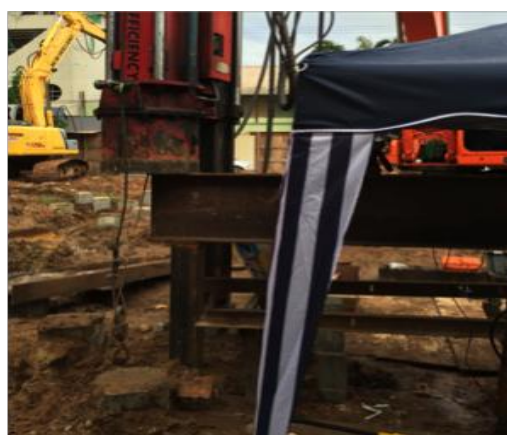
FIGURA 3.31 - PRENSA (PONTMAC), ADAPTADA E CALIBRADA PARA O SISTEMA, COLOCADA SOBRE VIGAS DE REAÇÃO. FONTE: DO AUTOR
