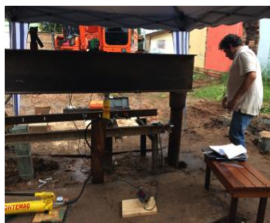
FIGURA 3.31 - PRENSA (PONTMAC), ADAPTADA E CALIBRADA PARA O SISTEMA, COLOCADA SOBRE VIGAS DE REAÇÃO. FONTE: DO AUTOR
