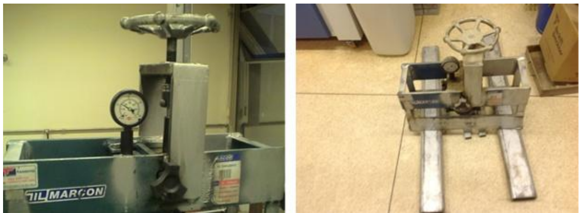
FIGURA 3.14 - PRENSA (MARCON), ADAPTADA E CALIBRADA PARA O SISTEMA, COLOCADA SOBRE VIGAS DE REAÇÃO FONTE: DO AUTOR
