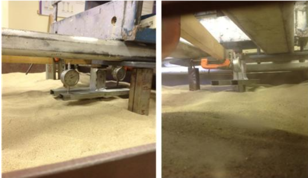
FIGURA 3.17 - EXTENSÔMETROS INSTALADOS SOBRE O CAP, E FIXADOS A ESTRUTURA INDEPENDENTE A ESTACA, DURANTE A PRIMEIRA BATERIA DE ENSAIOS. PRENSA FIXADA AO SISTEMA DE REAÇÃO POR CHAPA PARAFUSADA ABAIXO DO SISTEMA. FONTE: DO AUTOR
