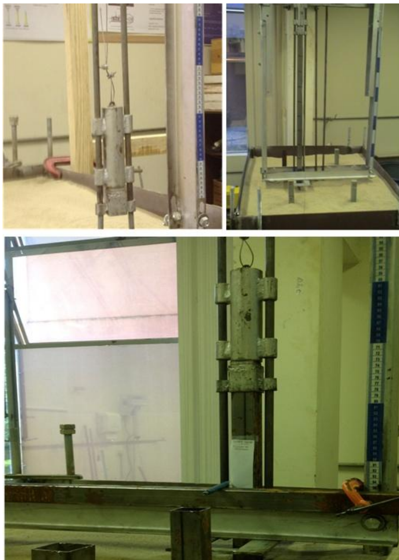
FIGURA 3.10 - DETALHES EXECUTIVOS DO MODELO: MARTELO DE 2 kgf, CAPACETE, CEPO DE MADEIRA, HASTES GUIAS DE 12,5 mm, CABO DE AÇO DE 3 mm, ESCALA CENTIMÉTRICA E TODO SISTEMA OPERANDO, INCLUSIVE COM A MEDIÇÃO DO REPIQUE FONTE: DO AUTOR
