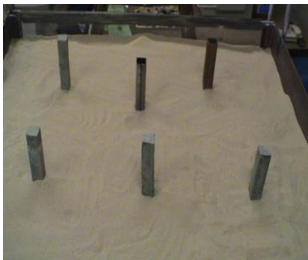
FIGURA 3.4 - LOCAÇÃO DAS ESTACAS NA CAIXA DE AREIA DURANTE PRIMEIRA BATERIA DE ENSAIOS FONTE: DO AUTOR
