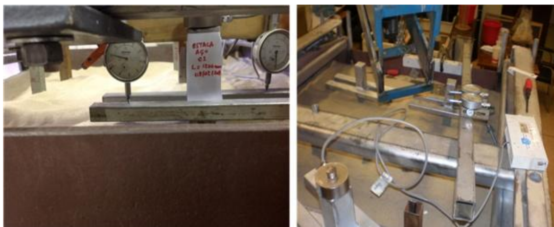
FIGURA 3.16 - DETALHE DO EXTENSÔMETRO LIGADO AO “CAP” INSTALADO SOB A ESTACA DE AÇO 1 DA 2ª BATERIA DE ENSAIOS FONTE: DO AUTOR
