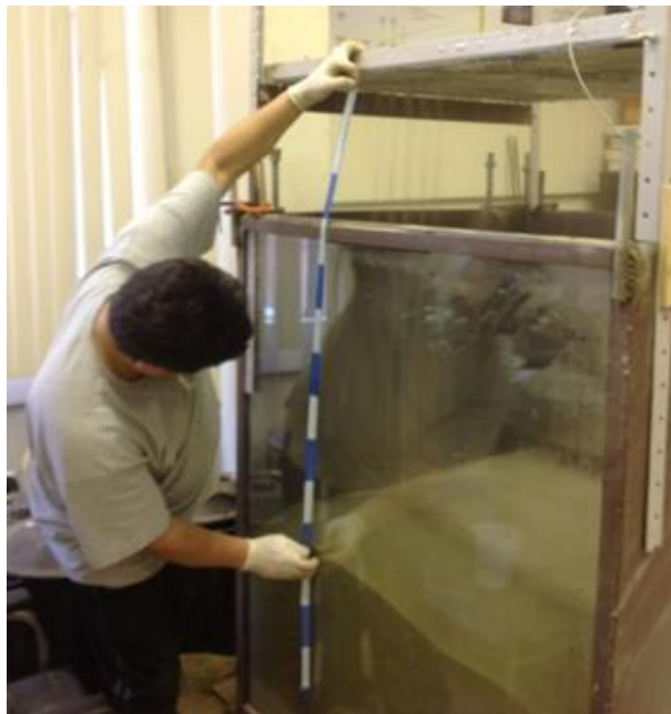
FIGURA 3.1 - CAIXA FORTE PROJETADA E CONSTRUÍDA COM VIDRO FRONTAL PARA ACOMPANHAMENTO VISUAL. FONTE: DO AUTOR
