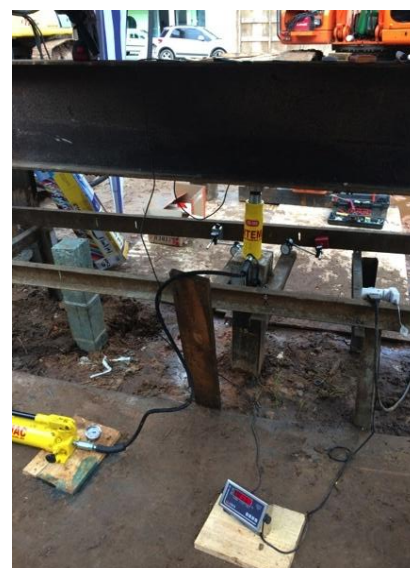
FIGURA 3.33 - ESQUEMA GERAL DA PROVA DE CARGA NA ESTACA DE AÇO A ESQUERDA E NA ESTAPET À DIREITA, COM MONITORAMENTO. FONTE: DO AUTOR
