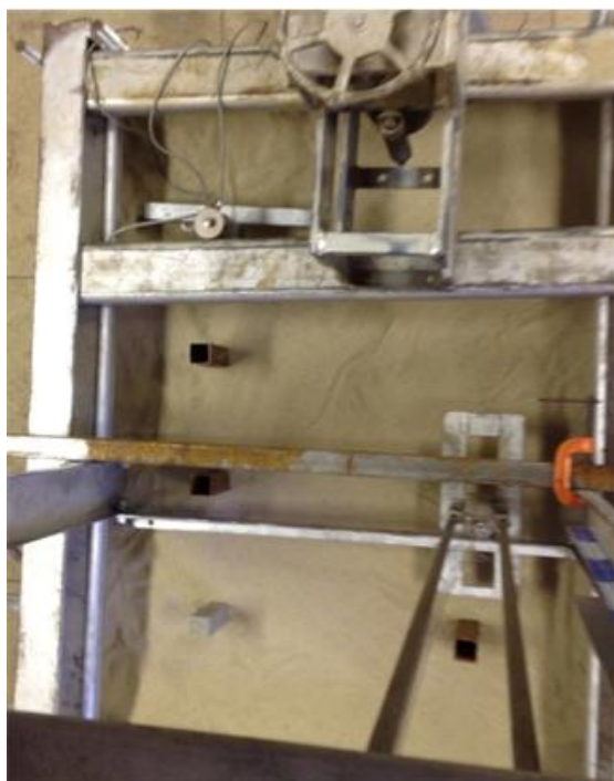
FIGURA 3.6 - LOCAÇÃO DAS ESTACAS NA CAIXA DE AREIA DURANTE SEGUNDA BATERIA DE ENSAIOS. FONTE: DO AUTOR
