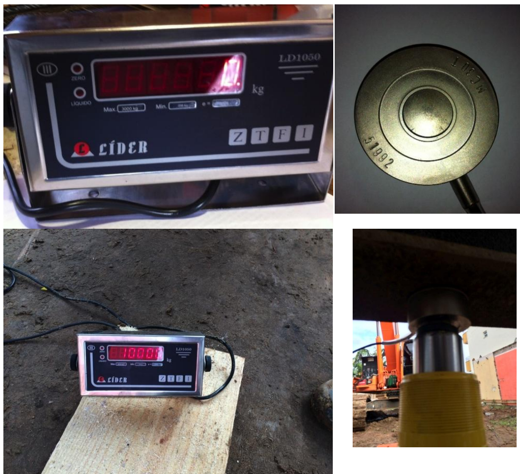
FIGURA 3.29 – LEITOR DIGITAL A ESQUERDA E CÉLULA DE CARGA À DIREITA (EM APLICAÇÃO NO EXPERIMENTO) FONTE: DO AUTOR
