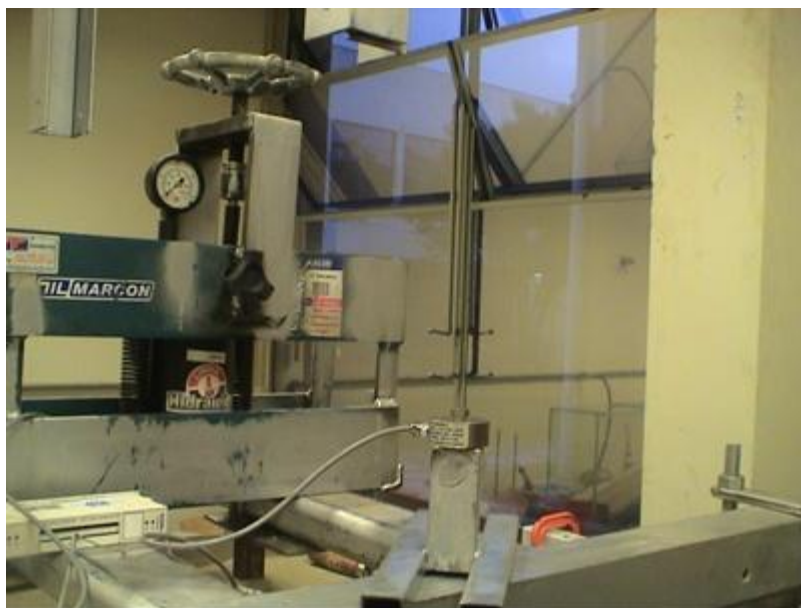
FIGURA 3.15 - PRENSA INSTALADA SOBRE AS VIGAS DE REAÇÃO E CÉLULA DE CARGA SOBRE O “CAP”, LIGADO AO DISPOSITIVO DE APLICAÇÃO DO LABVIEW. FONTE: DO AUTOR
