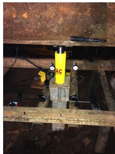
FIGURA 3.32 - DETALHE DO EXTENSÔMETRO LIGADO AO “CAP” INSTALADO SOB A ESTACA DE AÇO À ESQUERDA E A ESTAPET À DIREITA. FONTE: DO AUTOR
