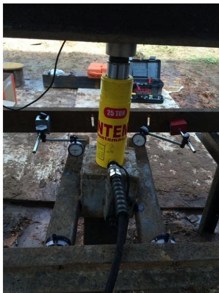
FIGURA 3.32 - DETALHE DO EXTENSÔMETRO LIGADO AO “CAP” INSTALADO SOB A ESTACA DE AÇO À ESQUERDA E A ESTAPET À DIREITA. FONTE: DO AUTOR
