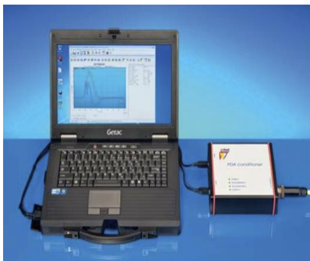
FIGURA 2.10 - FOTO DO EQUIPAMENTO DE MONITORAMENTO DO ENSAIO DLT FONTE: ARQUIVOS PESSOAIS
