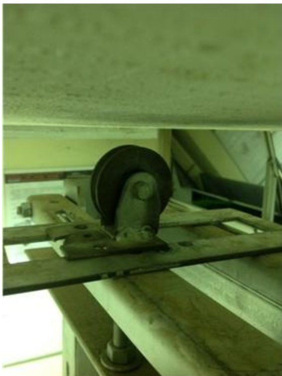
FIGURA 3.9 - POLIA DE DIÂMETRO 10 cm INSTALADA SOBRE A VIGA PRINCIPAL FIXA, QUE SUSTENTA TODO SISTEMA FONTE: DO AUTOR
