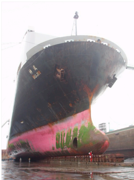
FIGURA 1 – BIOINCRUSTAÇÃO DE Ulva sp. NO CASCO DE UM NAVIO TRANSOCEÂNICO CARGUEIRO JAPONÊS.
