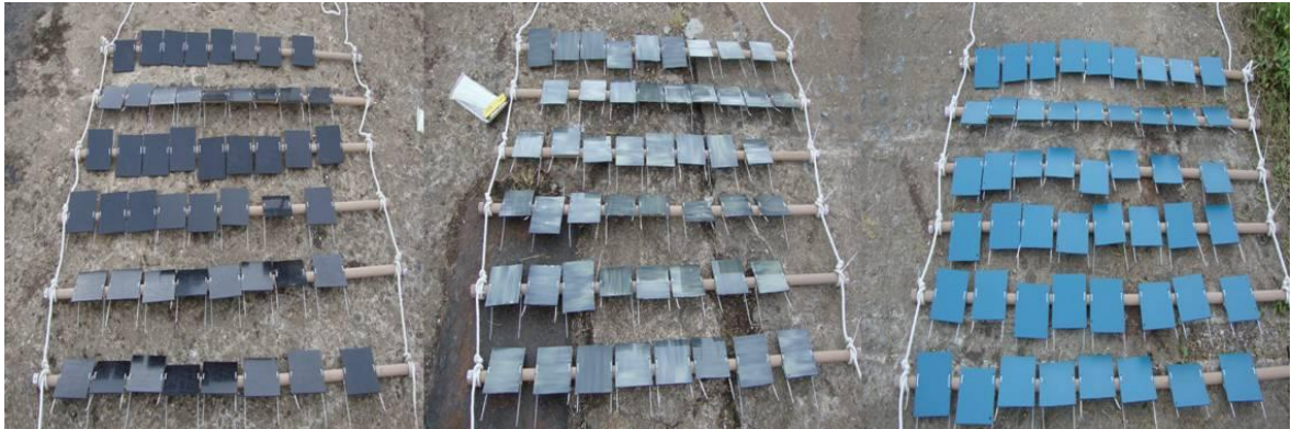
Figura 4. Estruturas com placas dos tratamentos controle, extrato de mamona e tinta anti-incrustante, respectivamente
