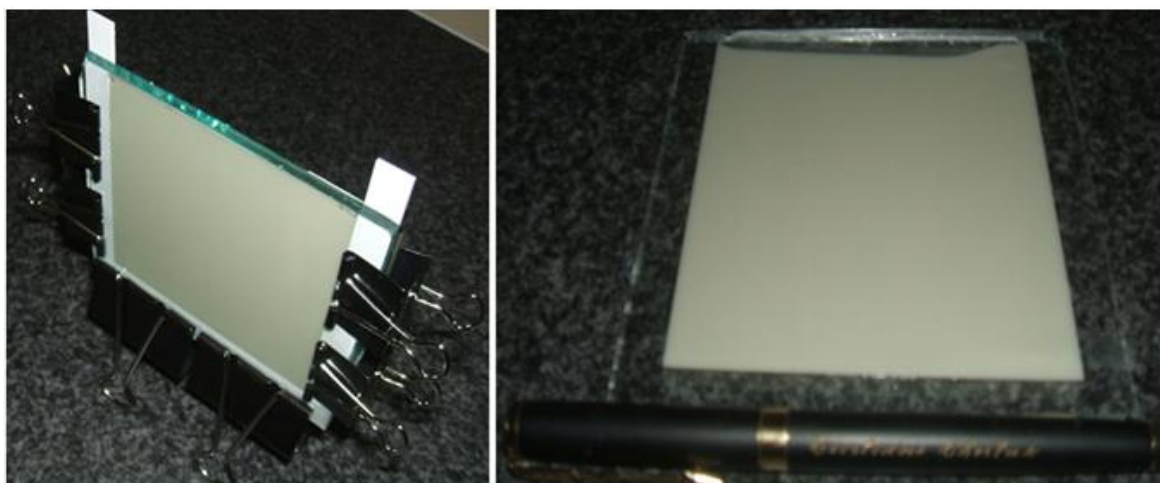
FIGURA 19. (A) SUPORTE PREENCHIDO COM O GEL (MONTMORILONITA IMOBILIZADA EM AGAROSE) NA PROPORÇÃO DE 12% ARGILOMINERAL E 1,5% DE AGAROSE. (B) GEL OBTIDO NA ESPESSURA DE 1 mm E TAMANHO APROXIMADO DE 11 cm x 10,5 cm.
