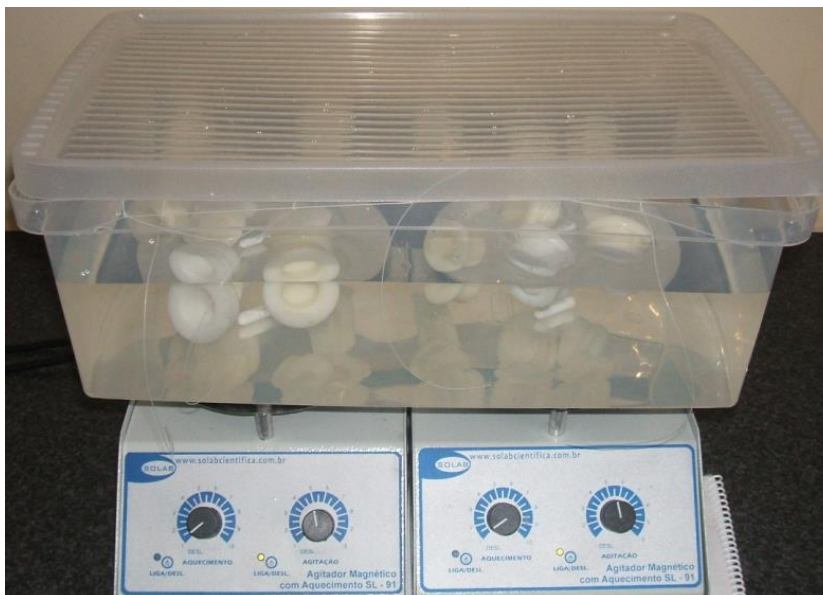
FIGURA 13. IMAGEM DO SISTEMA MONTADO PARA DESENVOLVER O EXPERIMENTO. CUBA COM CAPACIDADE DE 10 L SUPOSTADA SOBRE DOIS AGITADORES COM ROTAÇÃO EM TORNO DE 1300 rpm.
