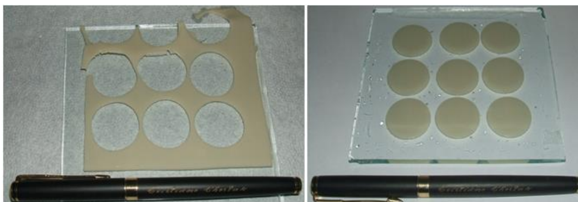
FIGURA 20. (A) RETALHO DE GEL DO QUAL FORAM TIRADOS OS DISCOS. (B) DISCOS NO DIÂMETRO DE 2,5 CM, PRONTOS PARA USO NO ESTUDO DE SORÇÃO.
