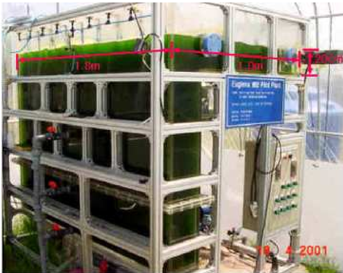
FIGURA 5. FOTOGRAFIA TRANSVERSAL DO FOTOBIORREATOR INOVADOR DE ESCALA PILOTO. FONTE: CHAE et al. (2005).
