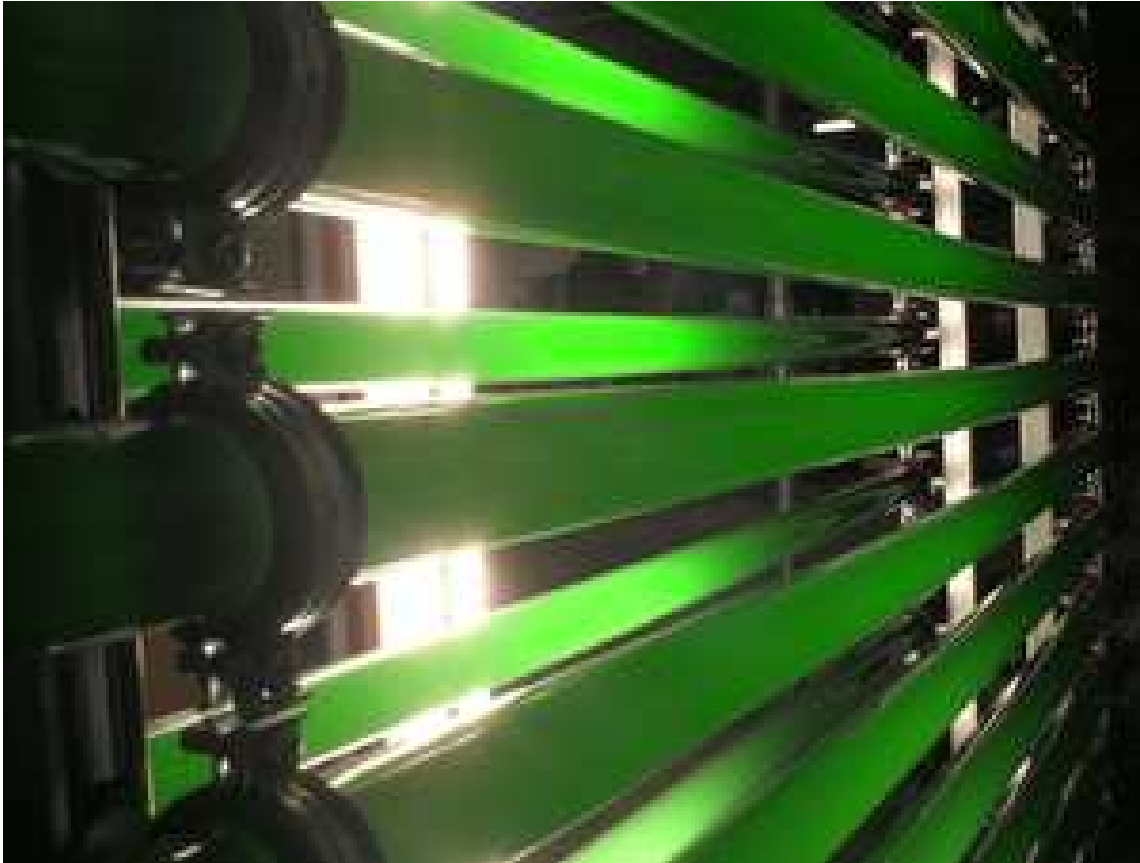
FIGURA 3. FOTOBIORREATOR TUBULAR. FONTE: AWI (2009).
