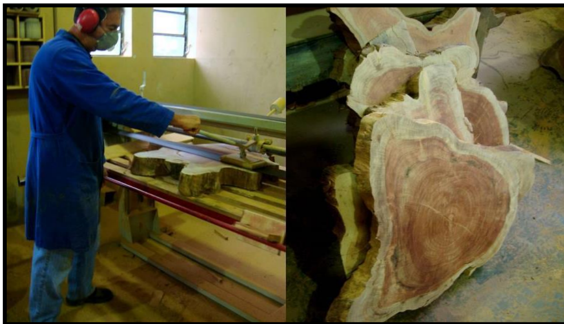
Figura 19. Preparo das amostras e discos lixados.
