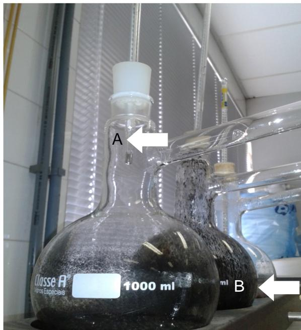
FIGURA 3.4 – FOTO DO APARATO SISTEMA ADOTADO INDICANDO OS PONTOS DE MEDIÇÃO DA TEMPERATURA DO VAPOR (A) E PERCOLADO (B)
