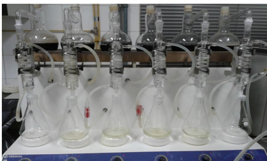
FIGURA 3.3 – FOTO DO EQUIPAMENTO TE-1256 – TECNAL UTILIZADO NOS ENSAIOS DE EVAPORAÇÃO DO PERCOLADO
