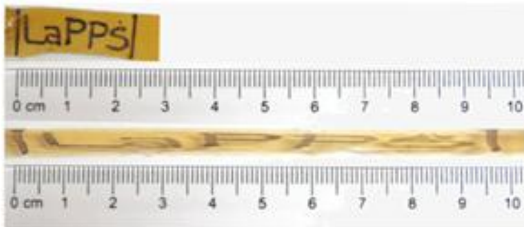
Figura 27 - Comportamento da elongação de amostra graftizada (CG 06), antes e durante a elongação.
