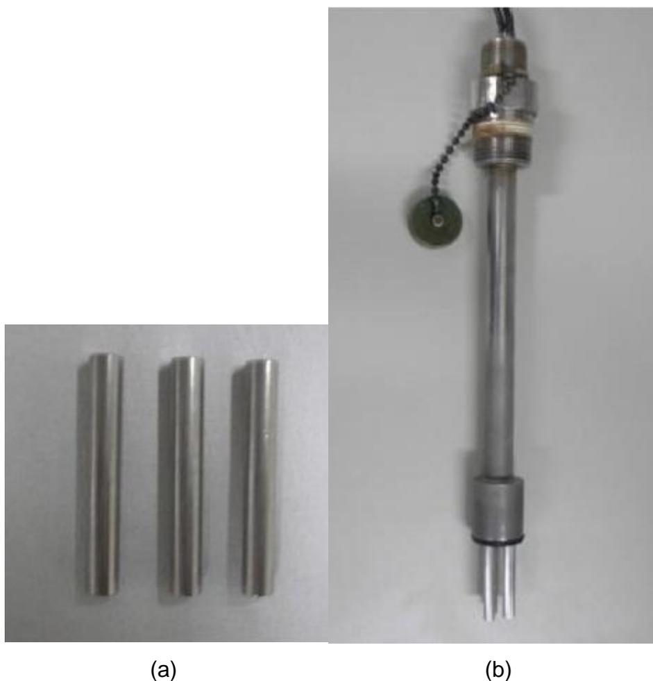
Figura 15 - (a) Eletrodos de teste em aço AISI 316; (b) sonda de contato com o interior do reator.
