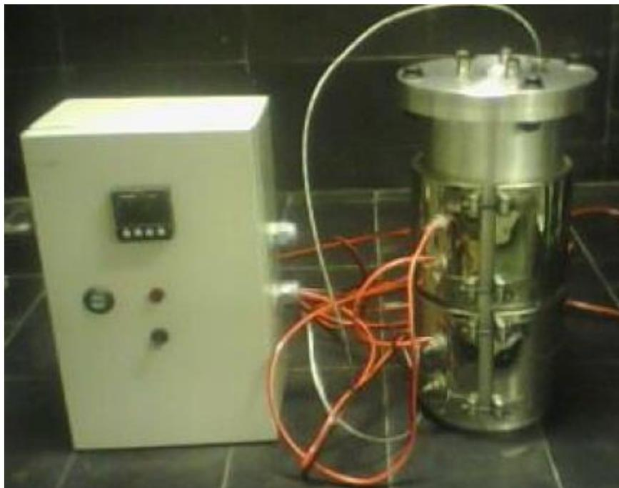
Figura 14 - Reator eletroquímico e sistema de controle de aquecimento.
