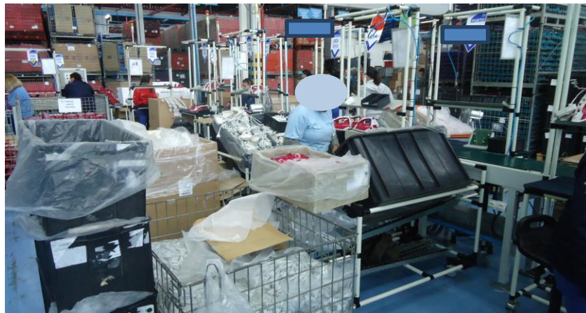
Figura 4.21. Excesso de estoque no ponto de uso na linha de montagem Fonte: Elaborado pelo Autor
