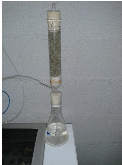
FIGURA 5 – COLUNA ENCAIXADA NO UMIDIFICADOR DE AR CULTIVADA COM A. oryzae EM BAGAÇO DE LARANJA E BAGAÇO DE CANA FONTE: A AUTORA
