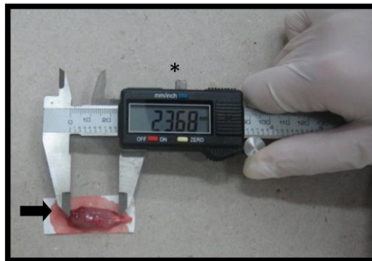
FIGURA 20- Mensuração do comprimento muscular com o paquímetro. Seta- músculo gastrocnêmio; Asterisco- medida realizada pelo paquímetro digital.
