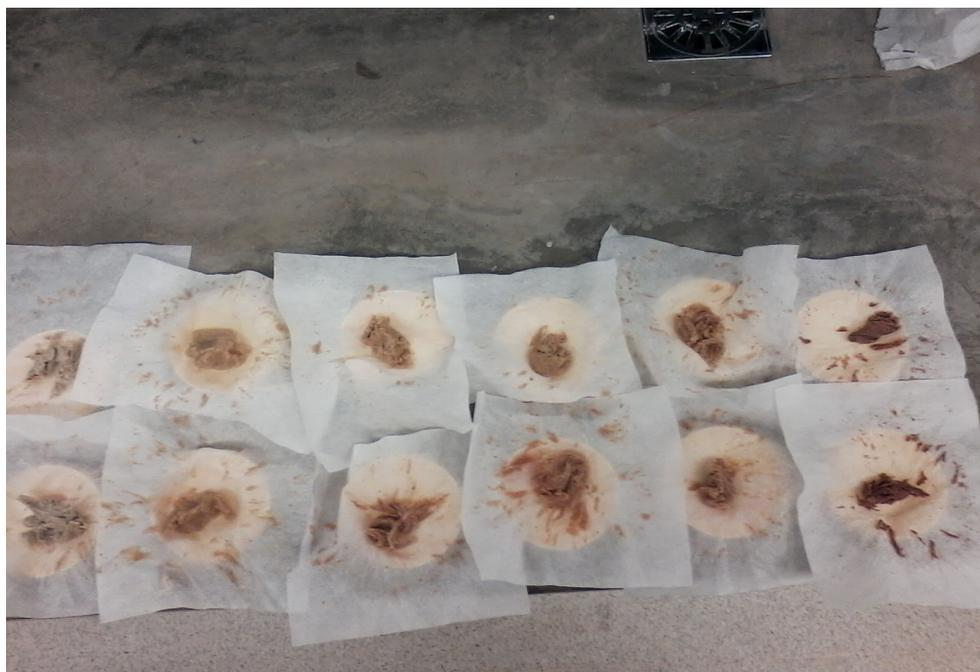
**FIGURA 7** - Extrato sólido após secagem na estufa a 80°C
