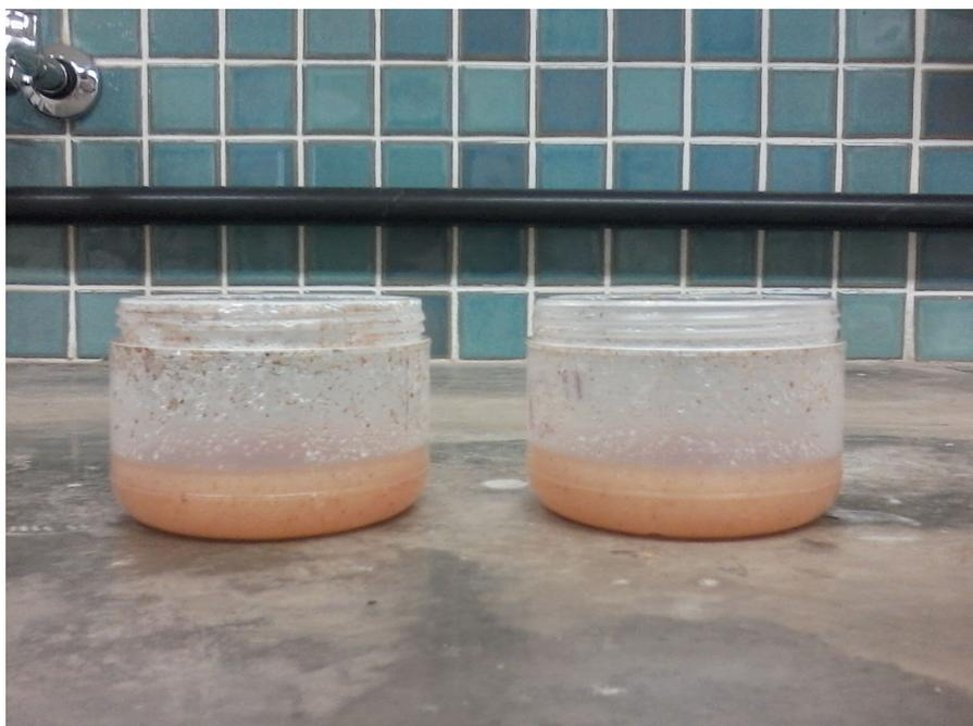
**FIGURA 5** - Amostras prontas para o ensaio hidrolítico ácido
