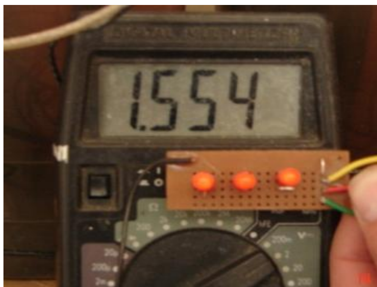
FIGURA 16. (A) Quatro células microbianas ligadas em série. (B) Detalhe para o potencial e leds acesos, sendo mantidos apenas pela energia gerada pelo sistema.
