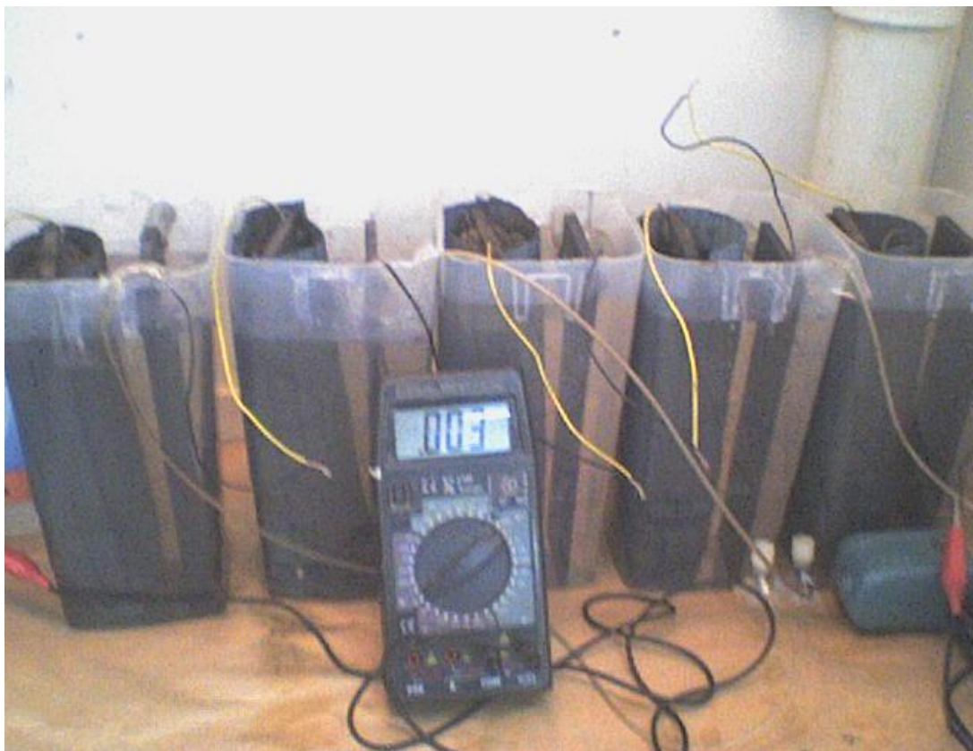
Figura 9 . Configuração da MFC composta por várias unidades individuais ligadas em série.
