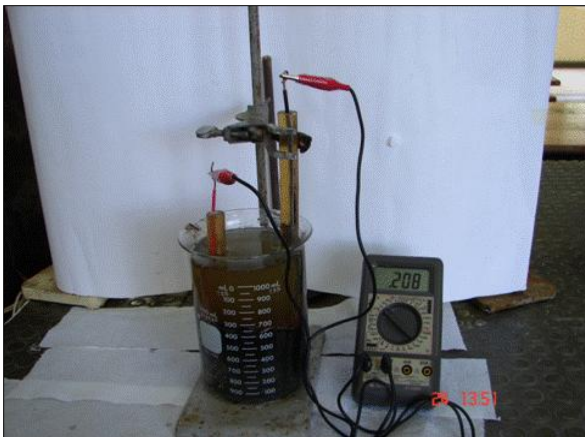
Figura 6. Célula eletroquímica do tipo sedimentar utilizando esterco suíno como fonte de material orgânico.
