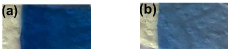
Figura 66. Imagem do filme de NTC após a eletroformaçao do \text{WO}_3 (a) e imagem de um filme de \text{WO}_3 obtido nas mesmas condiçoes do filme anterior, mas sem a presenca dos NTCs.
