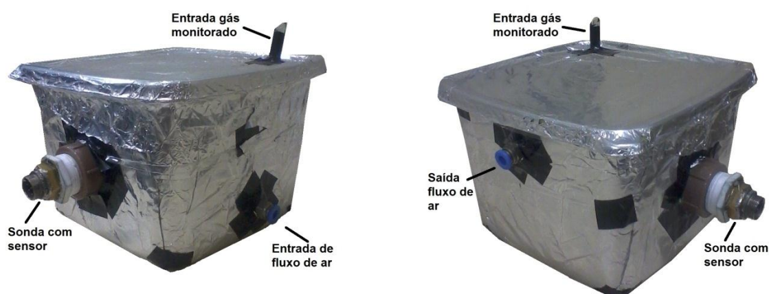
Figura 21 – Câmara com entrada e saída para fluxo de ar, entrada para gás a ser monitorado e local para suporte da sonda com sensor.
