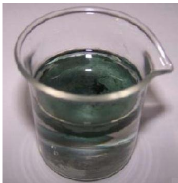
Figura 17 – Béquer contendo polianilina com nanotubos de carbono na interface água/tolueno [59].
