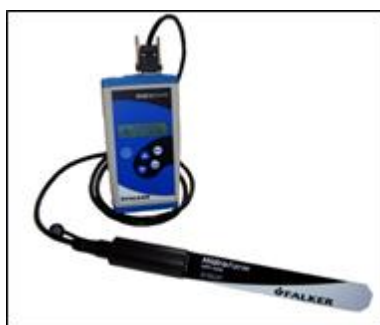
Figura 10. Aparelho Hidrofarm HFM 2010, utilizado para aferir a umidade dos lotes de cama de aviário e do composto produzido. Imagem retirada do website: www.falker.com.br
